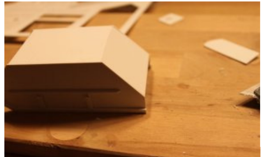
Die Verstärkungen vom Rand 2x Nr. 8 werden bündig angeklebt
