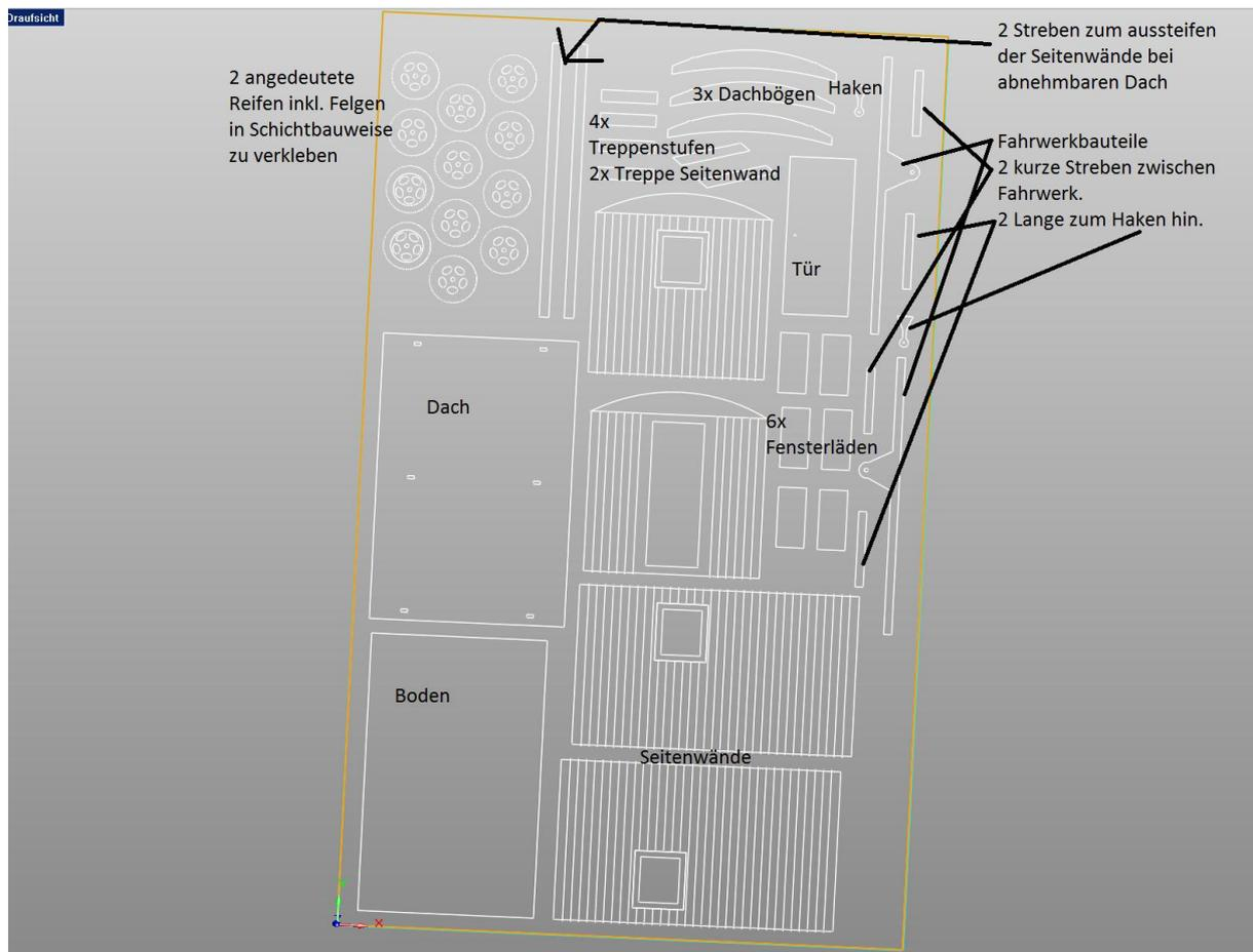
Die Treppenstufen unterscheiden sich je nach Bausatz in der Anzahl. Die Vertreibungen der Seitenwände sind auch nur bei den größeren Bausätzen enthalten.
