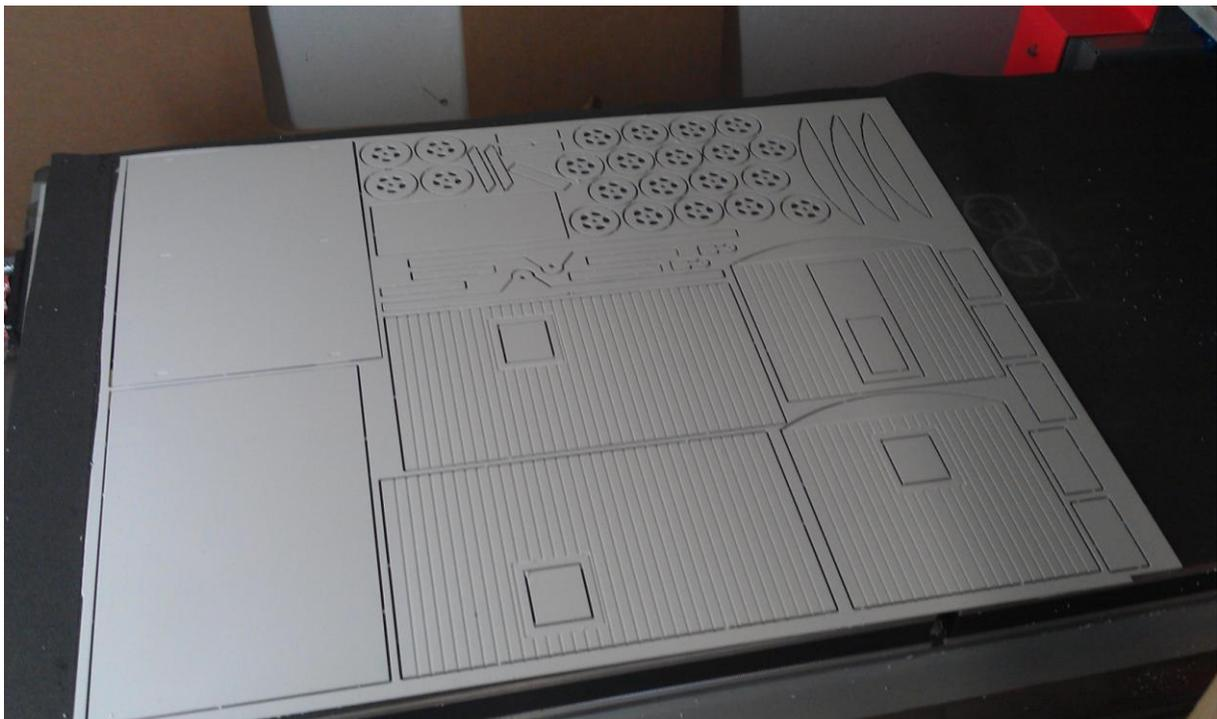
Bausatzteile der Wände müssen an den Kanten auf 45° Gehrung gebracht und dann auf den Boden geklebt.
