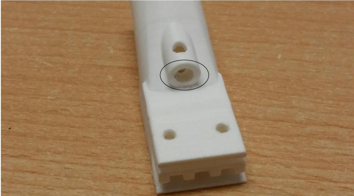
4. Das Stevenrohr wird aus Motorrichtung eingeschoben, so das die Bohrung für das Schmierrohr nach oben zeigt. Hier kann später Fett eingefüllt werden ohne die Welle demontieren zu müssen.
