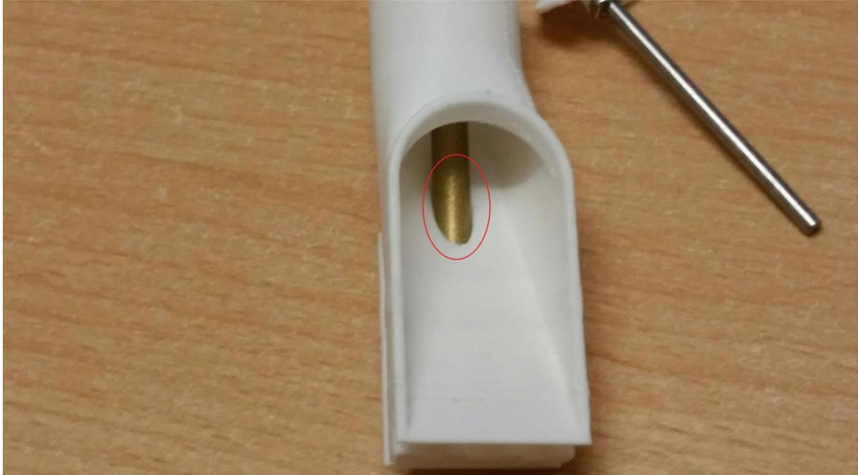
8. Zwei K1.8x5 Kunststoffschrauben werden von oben und unten in die Steurdüse gedreht. Eventuell Bohrung zuvor etwas weiten mit einem Bohrer **max.1.5mm!** Die Steurdüse muss sich leicht bewegen lassen nach einschrauben. Sollte das nicht der Fall sein etwas nacharbeiten an der Auslassdüse.
