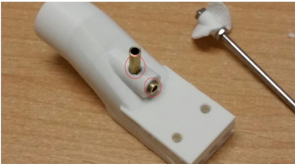
7. Auch auf der Wassereinlassseite wird um das Stevenrohr herum etwas Epoxidharz aufgetragen. Als recht ideal hat sich herausgestellt das ausgerichtete Stevenrohr von hier vor dem einkleben mit Epoxidharz mit flüssigen Sekundenkleber zu fixieren!
