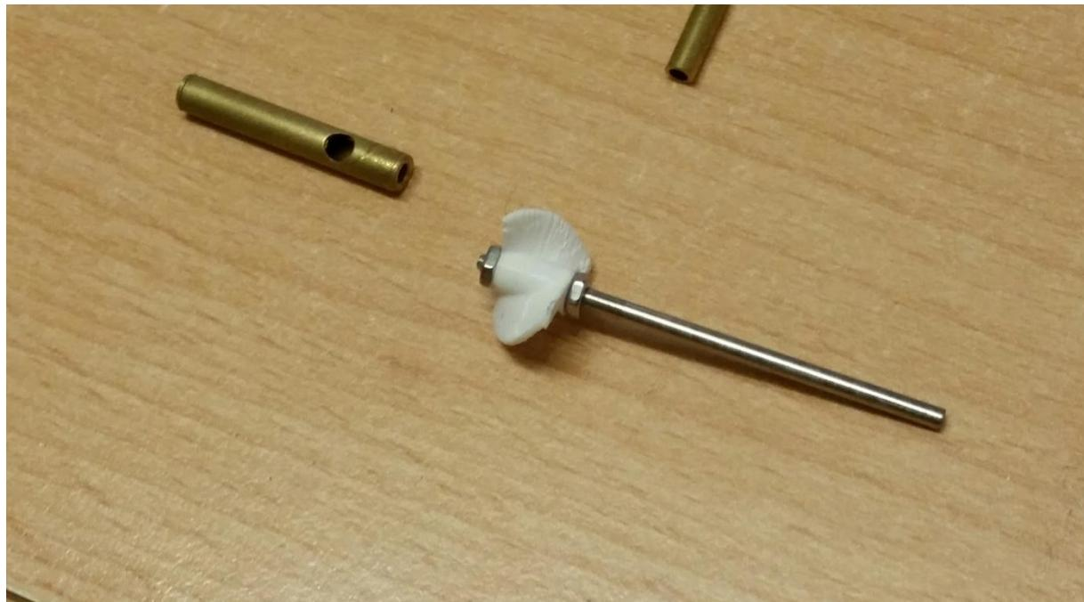
3. Die eingekreiste Bohrung für die Welle eventuell mit einem 4mm Bohrer bei langsamer Drehzahl im Akkuschauber etwas weiten, sofern sich das Stevenröhrchen überhaupt nicht einschieben lassen sollte. Die Bohrung dahinter von oben sollte 3mm haben. In die zwei vorderen zur Motorspant Befestigung werden M3 Gewinde eingebracht.
