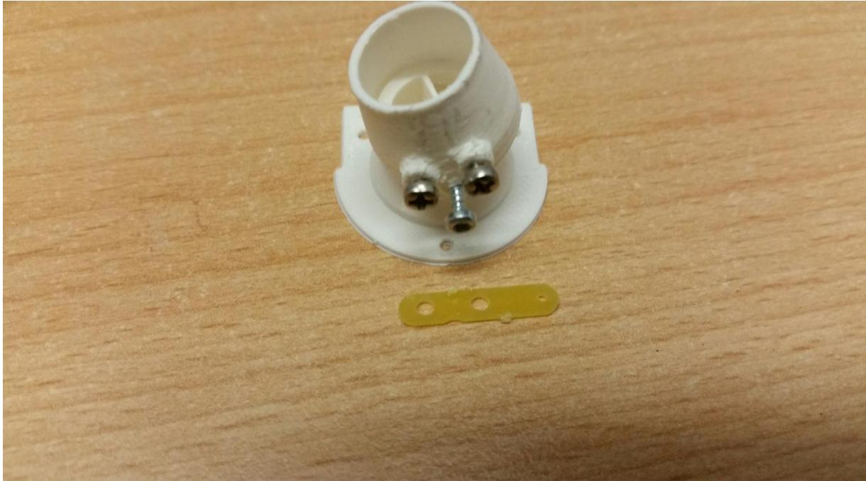
10. Der Halter für die Umkehrklappe kann aus 3 Teilen verklebt werden, auch hier Klebestellen etwas anschleifen und fettfrei machen. Zum verkleben benutzen wir flüssigen Sekundenkleber. Die zwei Bohrungen für die Umlenkklappe bekommen M2 Gewinde, in die später zwei Schrauben M2x3 eingedreht werden.
