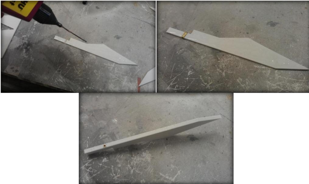
**17.** Das gleiche wie bei Schritt 16. wird nun für die Teile 7 und 8, sowie 9 und 10 mit den langen Röhren wiederholt. Hierbei muss noch jeweils das Teil 13 über das Röhren geschoben werden. Die Teile können nun erst mal wieder trocknen. Das mittig frei liegende Stück Rohr bei Teil 7/8 kann nach dem Trocknen entfernt werden. Ideal dafür eignet sich eine kleine Trennscheibe. Notfalls geht auch eine feine Säge. Die Positionen von Teil 13 so, wie auf den Bildern gezeigt verkleben.
