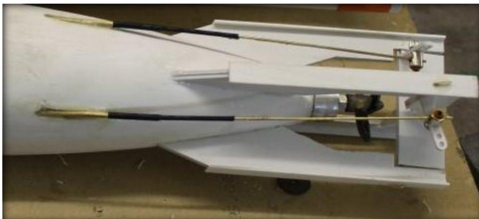
**23.** In die nun ausgerichtet und verklebten Halterungen können nun die Ruder eingesetzt werden. Ruderblatt 9/10/12 zwischen die Halterungen 5/6 setzen, so dass es als Tiefenruder dient. Ruderblatt 7/8/12 dann 90° gedreht als Seitenruder. Das dritte Bild zeigt gut die Lage der Ruderhörner von Oben betrachtet. Die Anlenkhebel liegen Oben am Rumpf entlang.
