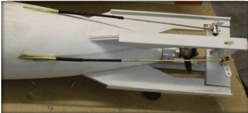
Der 1mm Messingdraht wird nun doppelt abgewinkelt und in die Ruderhebel des Servos eingeführt. Das dritte Loch von außen hat sich als gutes Mittelmaß herausgestellt. Auf der Ruderblattseite wurde jeweils ein **Servo Gestängeanschluss (nicht im Lieferumfang enthalten)** verwendet. Damit lassen sich die Ruder leicht einstellen.
