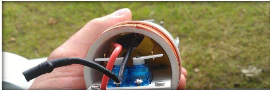
Als Regler wird ein Flug Brushless Vorwärtsregler mit 30A verwendet. E-Bay Suchbegriff: (Brushless Regler 30A) einfach einen mit möglichst kompakten Abmessungen suchen.
