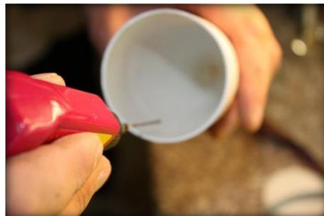
7. Nach dem Trocknen wird durch die Öffnung des Gussteils am Heckbereich das Loch für die Welle angezeichnet. Dieses Loch dann möglichst mittig auf fräsen D=6mm Bohren ist auch möglich, könnte aber zu ausreißen führen.
