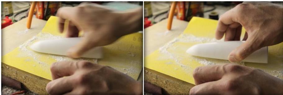
4. Nun werden die Hälften von innen und außen angeschliffen und danach zusammen geklebt. Hierbei in der Hand beide Teile genau ausrichten und von außen mit einem Tropfen möglichst dünnflüssigen Sekundenkleber zusammen heften. Dünnflüssig aus dem Grunde, weil dieser sich in den Spalt hinein zieht. Der Rumpf muss nun so stabil sein das er sich erneut sägen lässt!
