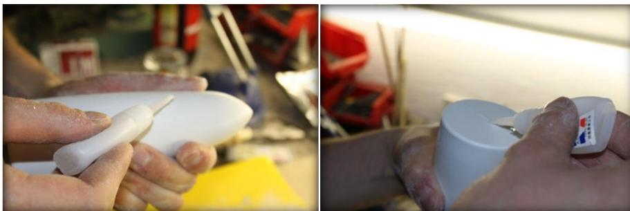
5. Als nächstes wird möglichst dicht am Rand mit einer Schnur oder einem Maßband im Kreis herum gezeichnet. Danach möglichst gerade absägen. Ideal war es dabei immer nur ca. 15-20mm Schnitte zu machen und weiter zu drehen. Der Rand wird danach wieder plan geschliffen. Wer auch hier möglichst gerade und dicht am Rand bleibt hat weniger Nacharbeit zu erledigen. Dieser Schritt ist für das vordere und hintere Schiffsteil durchzuführen.
