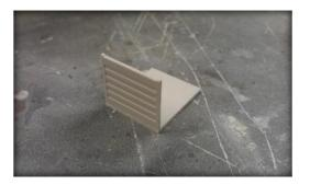
**3.** Nun wird das lange Seitenteil 3 an die lange Seite kleben. Darauf achten das die eingefrästen Nuten mit denen des kurzen Teils 2 überein stimmen. Notfalls nachmessen!
