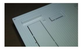
9. An die Tür werden jetzt die Scharnierteile 8 so angeklebt das die Bohrung rechts außerhalb des Türblattes steht.
