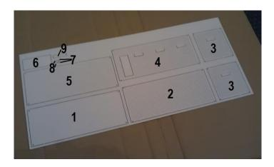
1. Als ersten Schritt wird die Platte beidseitig über geschliffen mit Schleifpapier mittlerer Körnung. Dann wird die Bodenplatte Teil 1 ausgetrennt und flach hingelegt.
