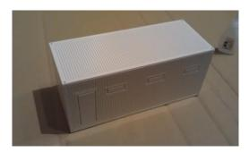
7. Hier werden nun die beiden Teile 7 mittig in die eingefrästen Taschen gesetzt. Das außermittig angeordnete Loch muss hierbei von der Tür weg nach rechts zeigen.
