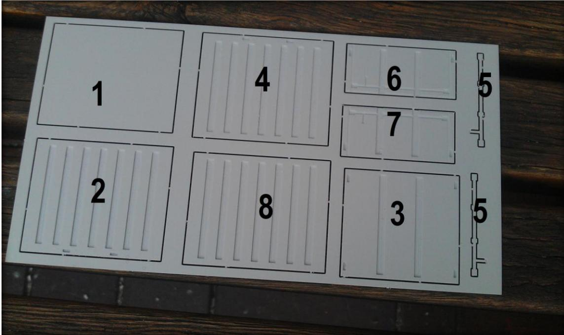
**1.** Platte mit Schleifschwamm aufrauen und Bodenplatte 1 und Seitenteil 2 austrennen und von den Stegen befreien. Danach die Seitenplatte 2 auf die Bodenplatte kleben so dass sie bündig abschließt. Hierbei darauf achten das die zwei gefrästen Taschen unten sind (siehe Bild)
