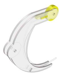
**10.** Die nun entstandenen sechs Greifereinheiten können nun an den Kopf montiert werden mit M3 Schrauben.
