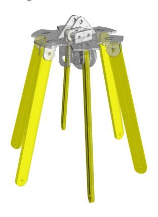
**6.** Die untere Kopfplatte 7a wird zusammen mit den Halteblechen 8 und der oberen Kopfplatte 7b verklebt.
