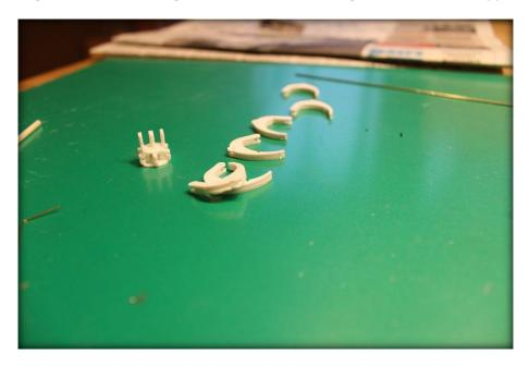
**6.** Danach wird die Schale aufgeklebt. Die eingefräste Nut beachten.
