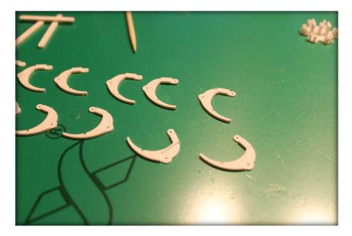
**5.** nun werden die Bauteile zusammen geklebt. Bitte zuvor testen ob die Plattenstärke noch dazwischen passt von 1.5mm, damit die Stangen auch leicht beweglich sind. Bitte auch hier den Lack berücksichtigen! Notfalls die Stangen etwas schmaler schmirgeln wenn das zu knapp erscheint!
