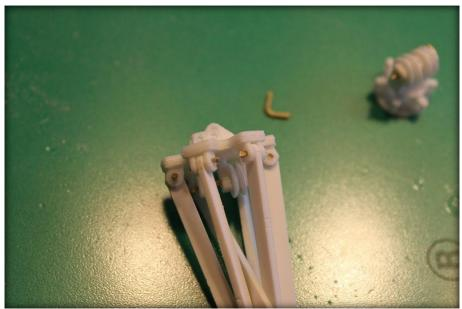
**10.** Als letztes werden dann die Greifereinheiten mit dem unteren kopf verbunden und dann beide Bauteile zusammen.
