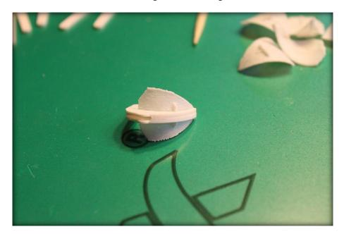
7. Die 3D Druckteile vom Kopf werden so übereinander verklebt. Die kleine Bohrung die durch beide Teile geht dient als Positionierhilfe!
