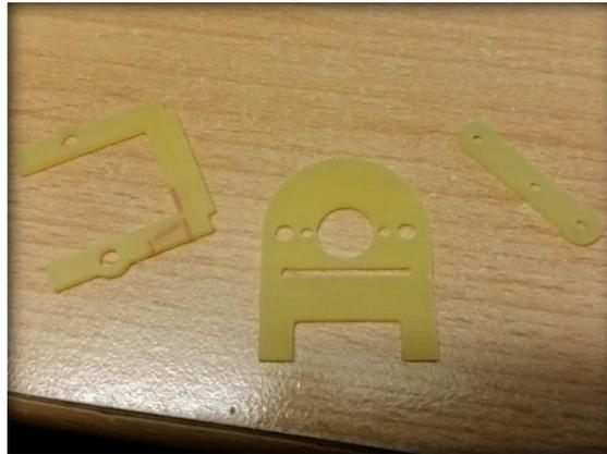
12. Die vom fräsen runden Innenecken müssen nun mit einer Feile oder einem Messer auf 90° Winkel gebracht werden. Danach die Teile zusammen stecken und im 90° Winkel zueinander mit flüssigen Sekundenkleber verkleben. Am besten dünn von beiden Seiten in die Ritzen laufen lassen.
