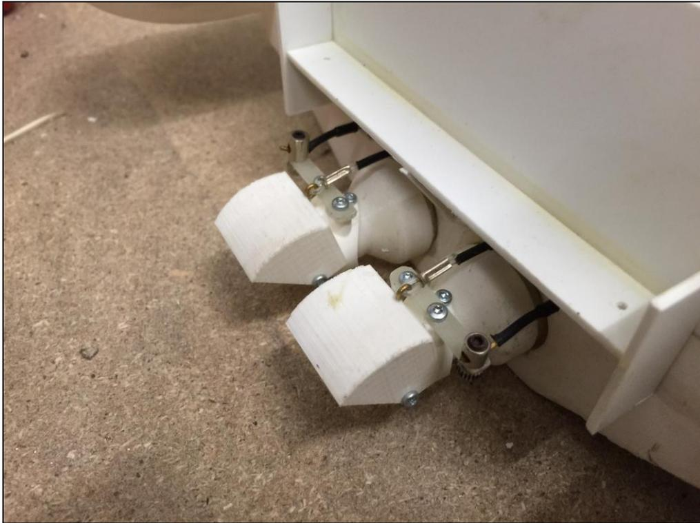
Hier sieht man noch einmal Jets eingesetzt im Modell von oben. Hier wurden spezielle Motorhalter gefertigt zur Aufnahme der großen Motoren.
