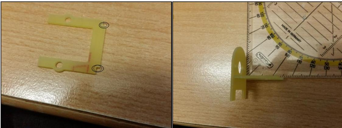
13. Kurzer Test ob der Motorhalter auch passt. Die zwei Füße können später noch in der Höhe angepasst werden, je nachdem wie tief der Jet eingeklebt wird im Rumpf. **Wer möchte kann den Motorhalter dann ganz zum Schluss auch noch mit dem Rumpf verkleben über die Füße. Aber dies wirklich erst machen wenn alles 100% ist.**
