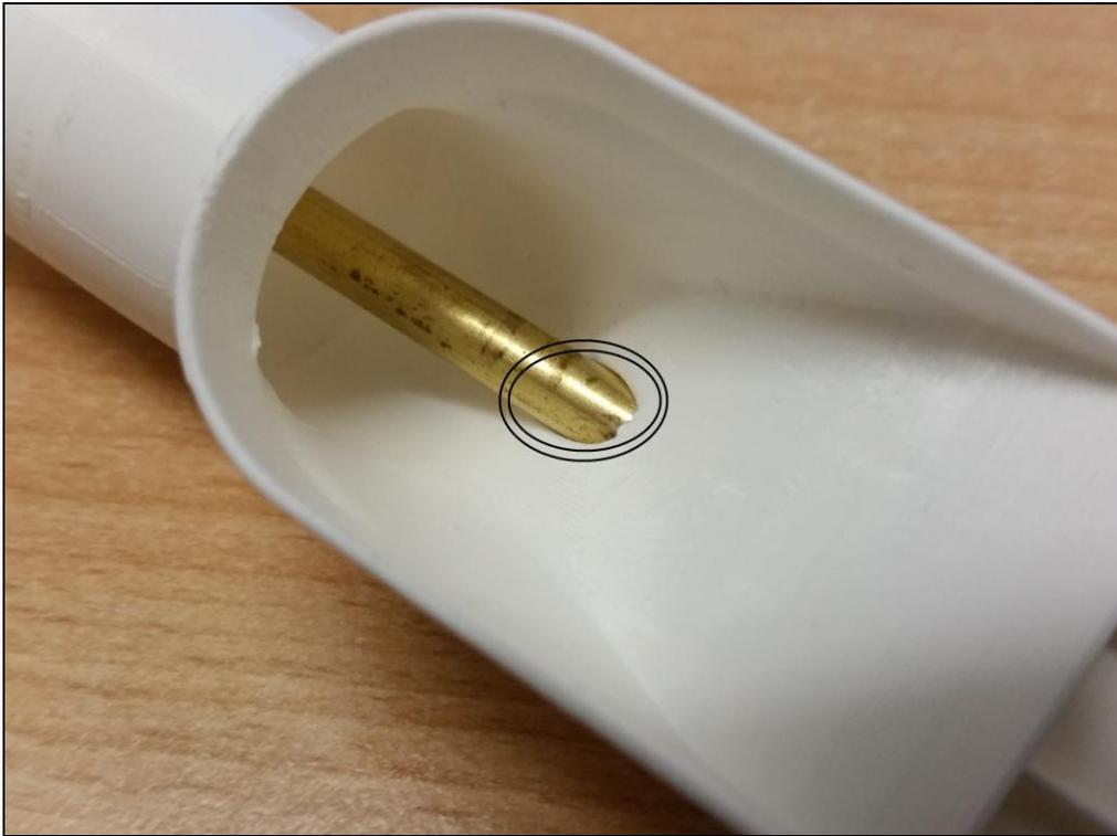
10. Der letzte Rest Kleber wird verwendet um auch den Schmiernippel in sein Loch zu kleben. **Zuvor bitte auch hier kurz versuchen ohne Klebstoff den Schmiernippel einzuschieben um das Loch entsprechend aufzuweiten. Und darauf achten das kein Kleber in das Stevenrohr eindringen kann.**
