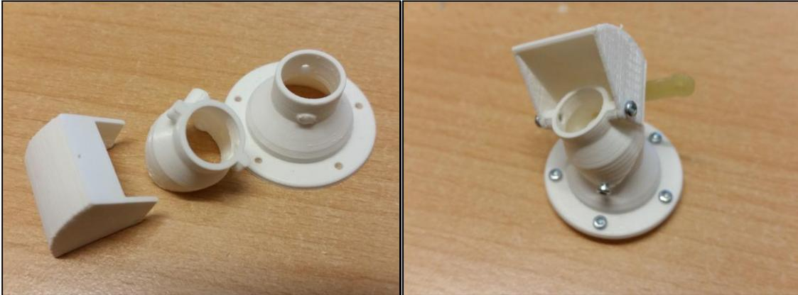
15. Der Anlenkhebel wird ebenfalls von oben mit den Schrauben eingeschraubt. Die Schrauben durch die Düse dienen später zur Befestigung im Rumpf. Natürlich können hier auch Schrauben gewählt werden die unter Umständen länger sind oder besser zum Rumpf passen.
