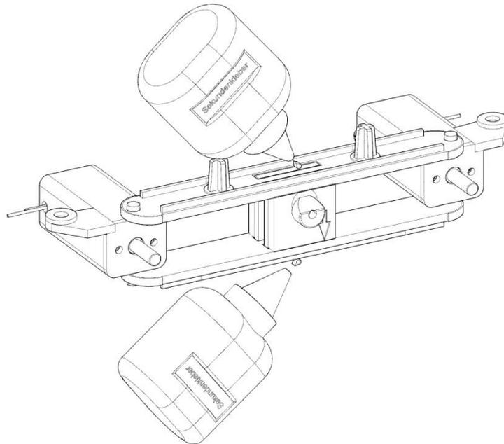
Die Lenkstange mit Hilfe der M3x10mm Schrauben und den Selbstsichernden Muttern verbinden. Ratsam ist da einmal festzuziehen und dann nach und nach die Mutter zu lösen bis die Achse leicht läuft.
