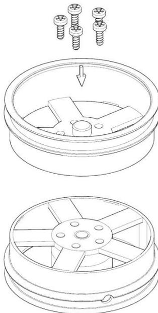
Für eine gute Verbindung der Felgen Außen eine Naht mit dünnflüssigen Sekundenkleber herstellen.
