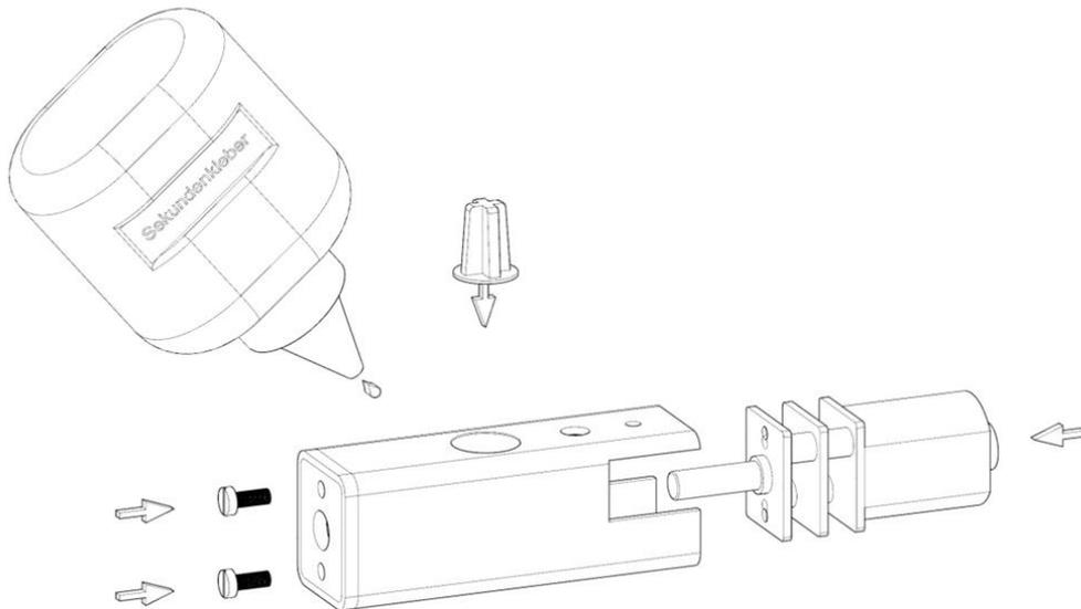
Die Kabel durch die Bohrungen schieben, anschließend die Achsen mit Hilfe des Verbinders zusammenschieben und mit den Torxschrauben verschrauben.
