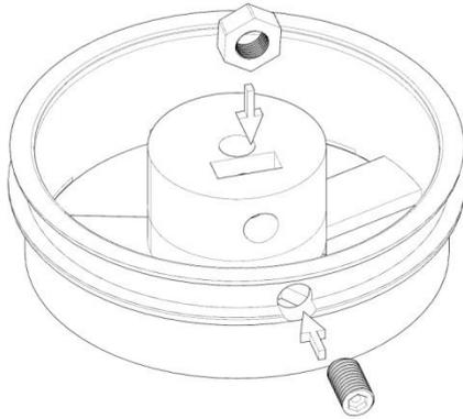
Felgen Ober- und Unterseite mit den Torxschrauben verbinden.
