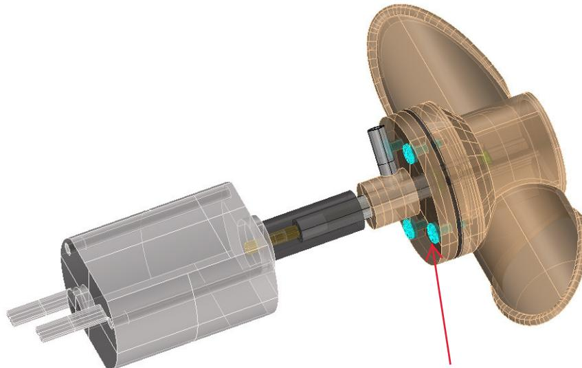
4. Vor dem Verschrauben gucken das der Propeller leicht dreht, ansonsten etwas nachschleifen. Dann mit Hilfe der Schrauben den Deckel aufschrauben.
