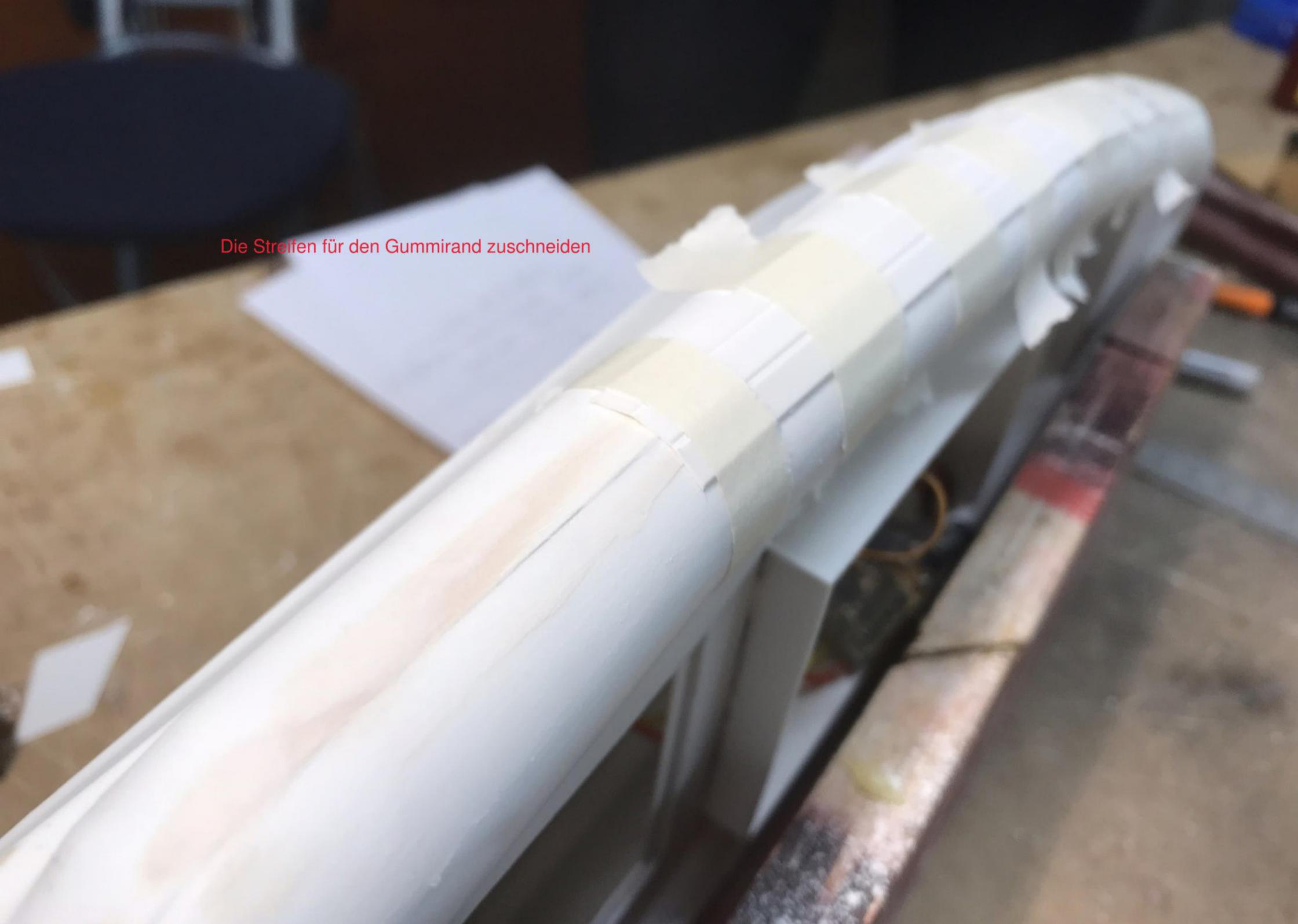
Beim Verkleben mit Hilfe von Klebestreifen Ausrichten.
