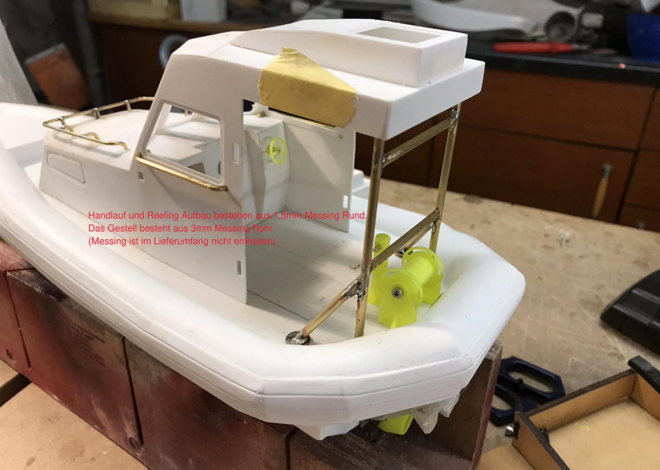
Handlauf und Reeling Aufbau bestehen aus 1,5mm Messing Rund.
