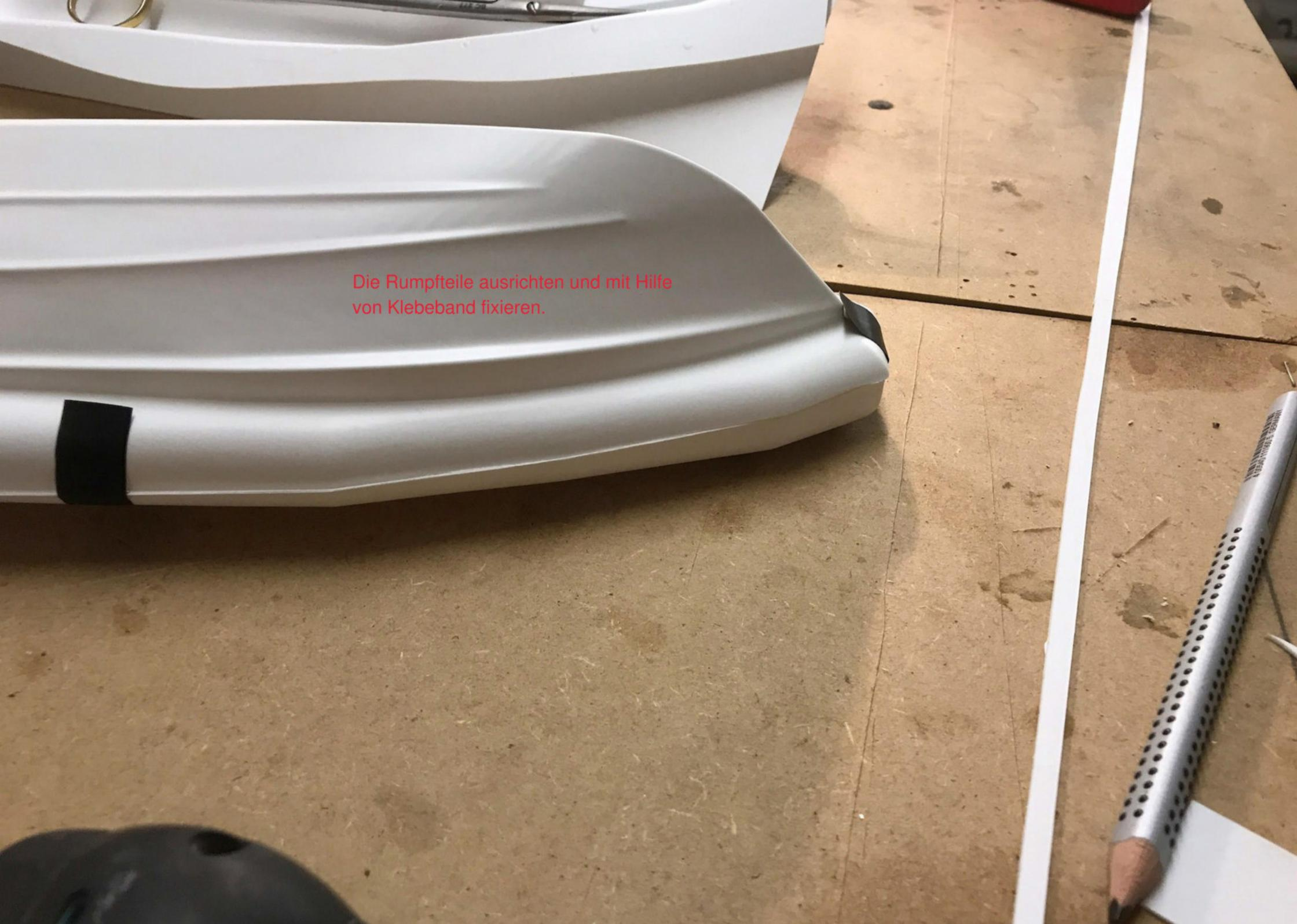
Die Rumpfteile ausrichten und mit Hilfe von Klebeband fixieren.
