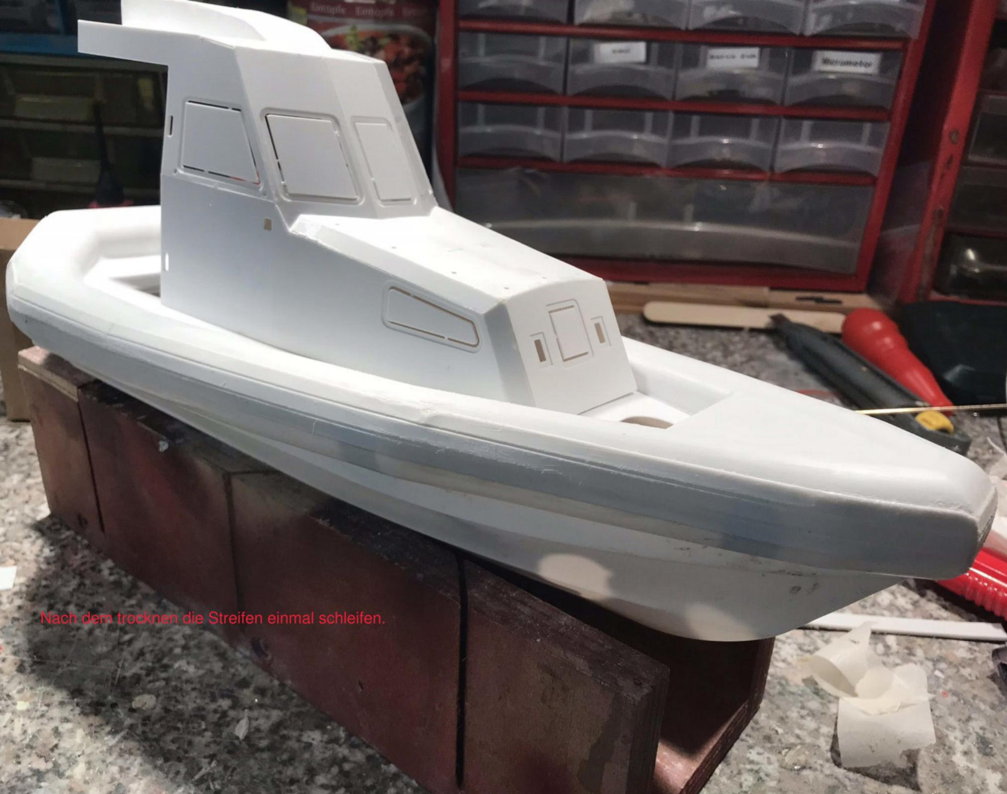
Nach dem trocknen die Streifen einmal schleifen.
