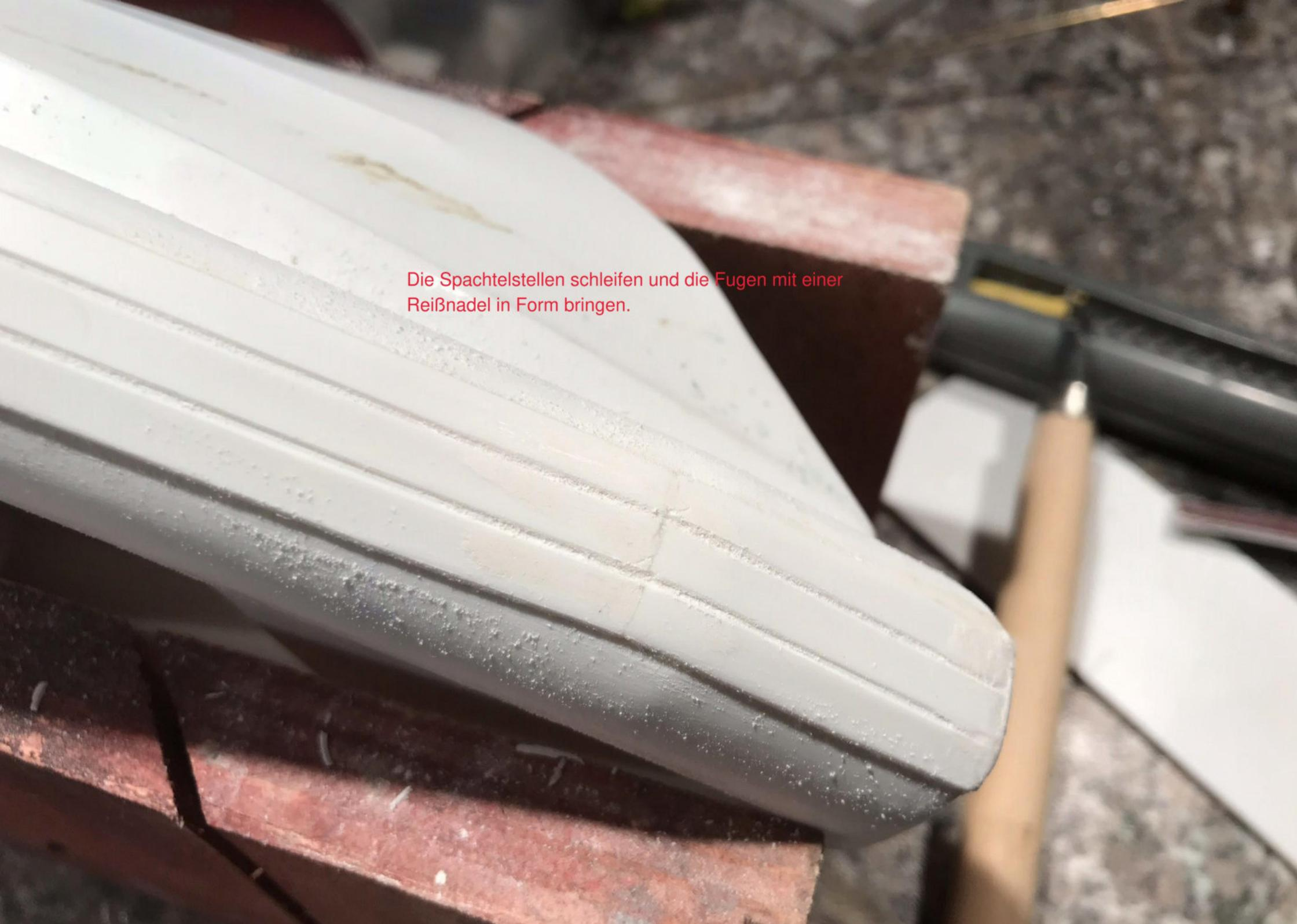
Die Spachtelstellen schleifen und die Fugen mit einer Reißnadel in Form bringen.
