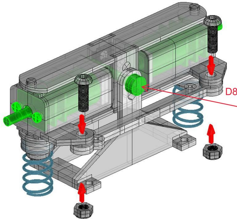
5. Die Lenkstange D8 verschrauben, die Schrauben nur so fest ziehen das die Lenkung leicht beweglich ist.
