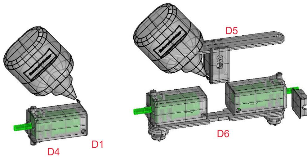
3. Kabel an die Motoren löten und im Achskörper einschrauben. Kabel durch die Öffnung führen. Die Kappen D1 und D2 anpassen und mit einem Tropfen Kleber fixieren.
