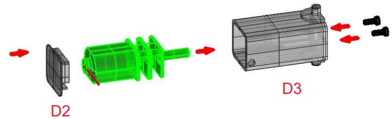
4. Die Achskörper D3 und D4 in das Teil D6 setzen. Das Teil D5 Aufsetzen ausrichten und verkleben.
