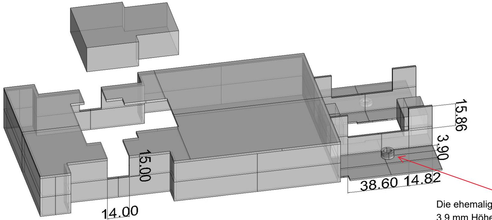
Die ehemaligen Buchsen werden auf 3.9 mm Höhe abgeschnitten. Außen herum müssen die Teile so beschliffen werden, dass die Feder darüber zu schieben geht (ca. 7,8mm).
