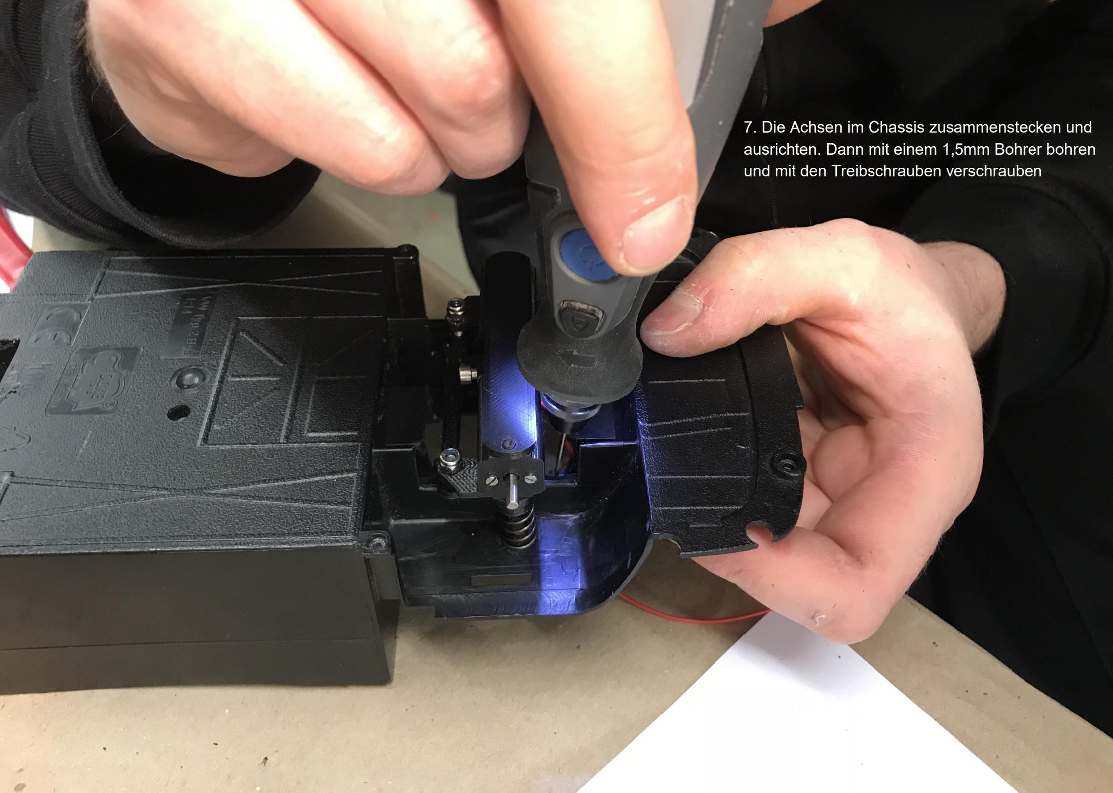
7. Die Achsen im Chassis zusammenstecken und ausrichten. Dann mit einem 1,5mm Bohrer bohren und mit den Treibschrauben verschrauben
