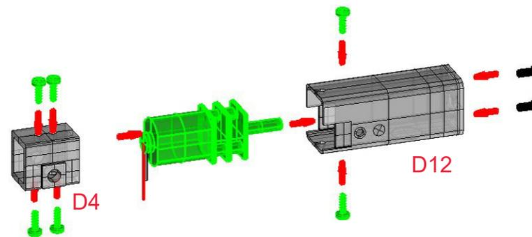
1. Kabel an die Motoren löten und im Achskörper einschrauben. Die Kabel durch die Öffnung der Achsen führen und die Achse zusammensetzen und mit den Treibschrauben verschrauben.
