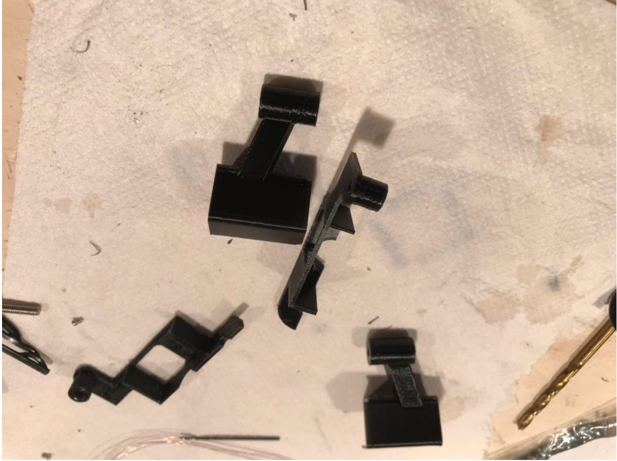
Beide Seitenteile miteinander verkleben. Sekundenkleber. Zuvor aber genau anpassen!
