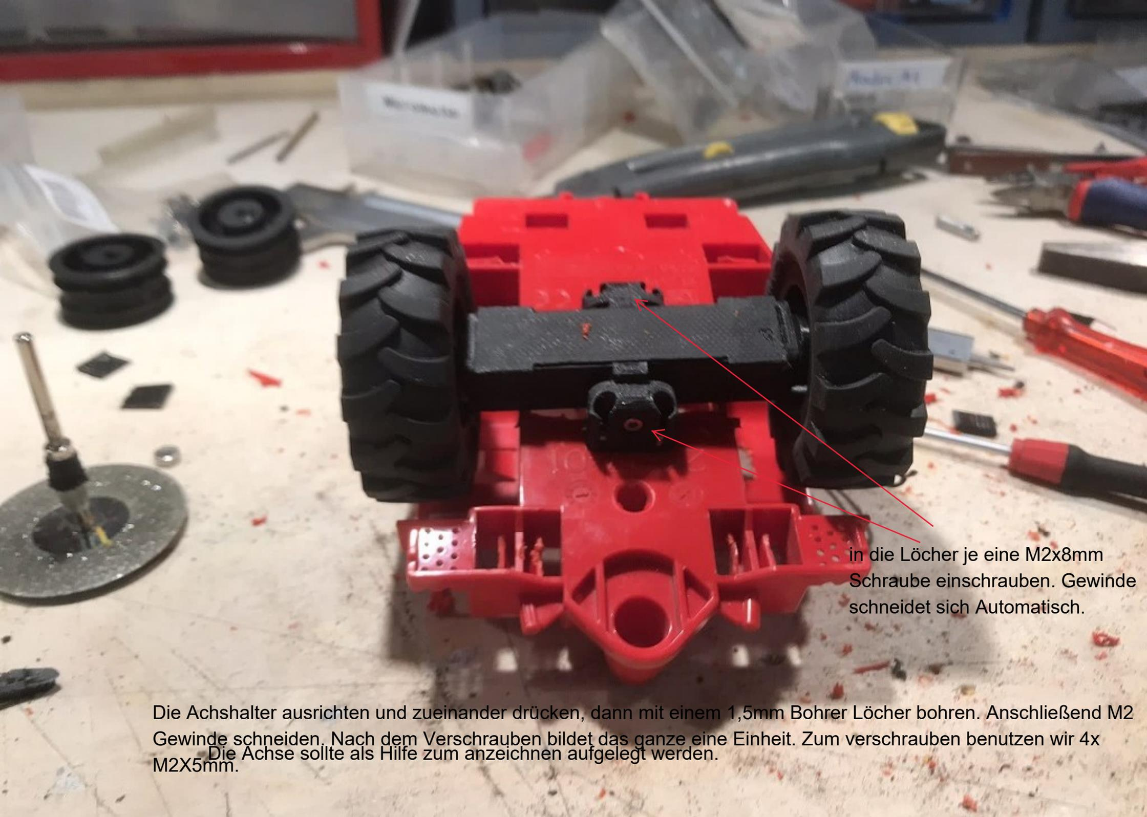
in die Löcher je eine M2x8mm Schraube einschrauben. Gewinde schneidet sich Automatisch.
