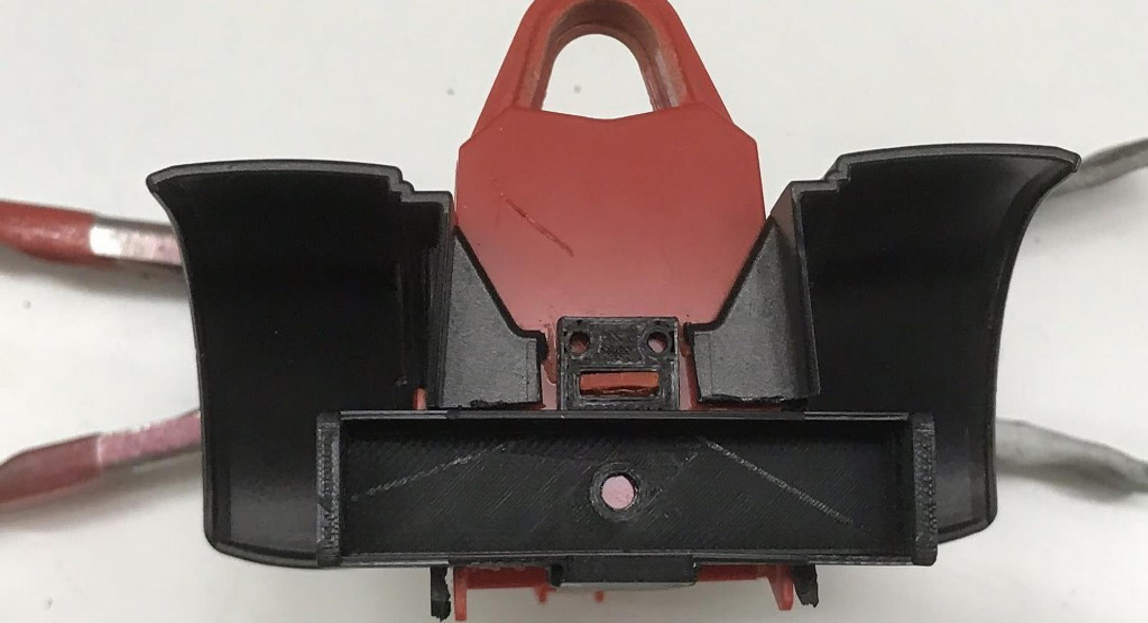
Wenn alles fertig bearbeitet ist schiebt man die Achse von vorne auf. Bohrt zwei 1,5mm Löcher, schneidet M2 Gewinde und verschraubt die Achse mit 2x M2X5mm Schrauben. Das Loch Mittig der Achse dient zur Durchführung der Kabel, in das Bruder Chassis ein 4mm bohren.
