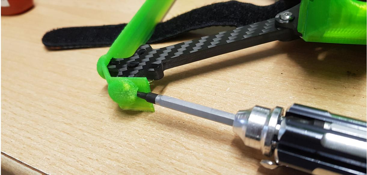
Die Sidewings lassen sich mit Hilfe eines Stiftes, Inbus, etc. über die Haken ziehen. Somit fallen die auch bei Harten Einschlägen zu 99% nicht ab.
