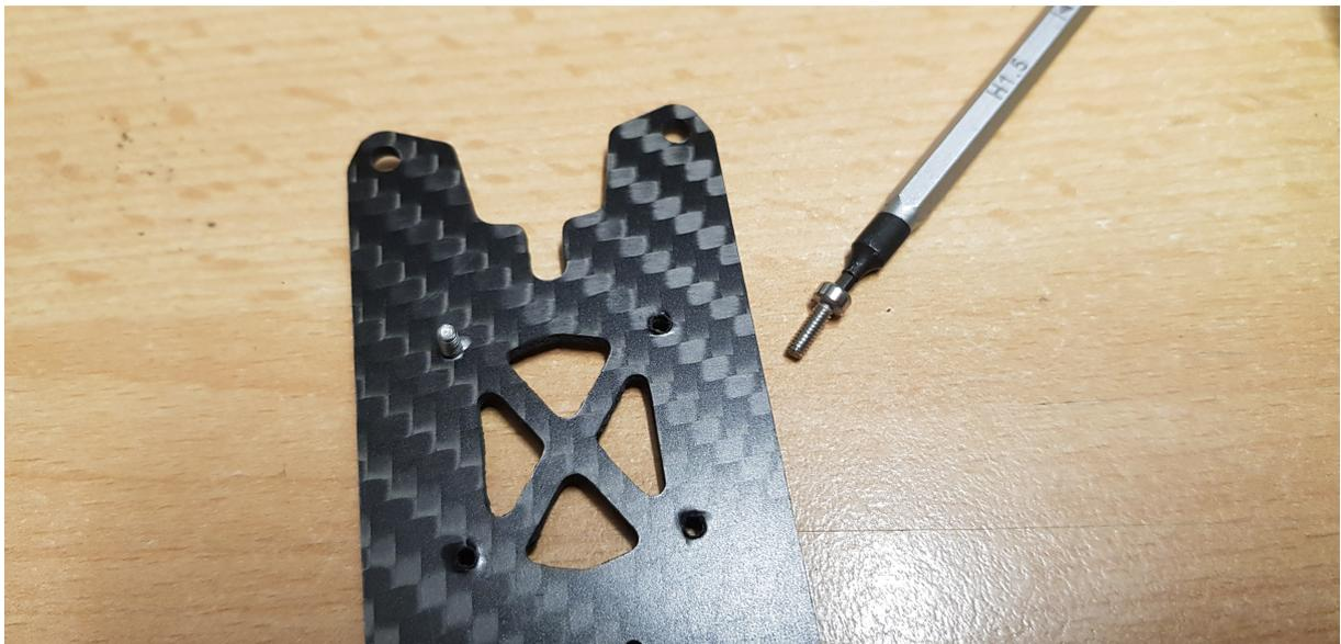
In die Bohrungen kommen die M2x5mm Schrauben um die Finne hinten zu fixieren
