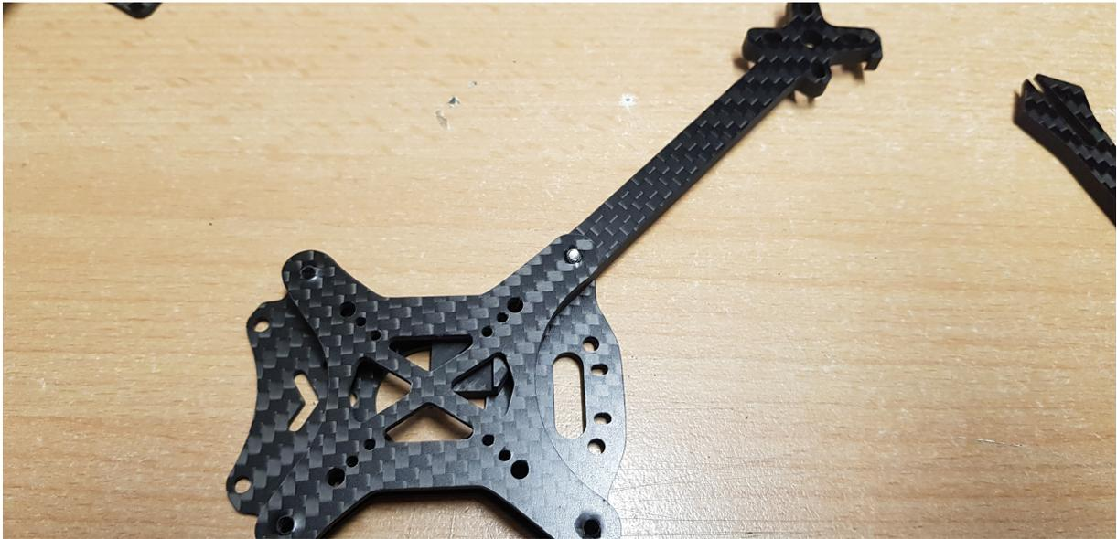
Als erstes wird ein Arm wie angesprochen mit der Aussparung zur Kreuzplatte hin mit einer M3x10 Schraube angeschraubt. Idealerweise mit etwas Schraubensicherungslack, damit ein eigenständiges Herausdrehen aus der CFK Platte weitestgehend vermieden werden kann.
