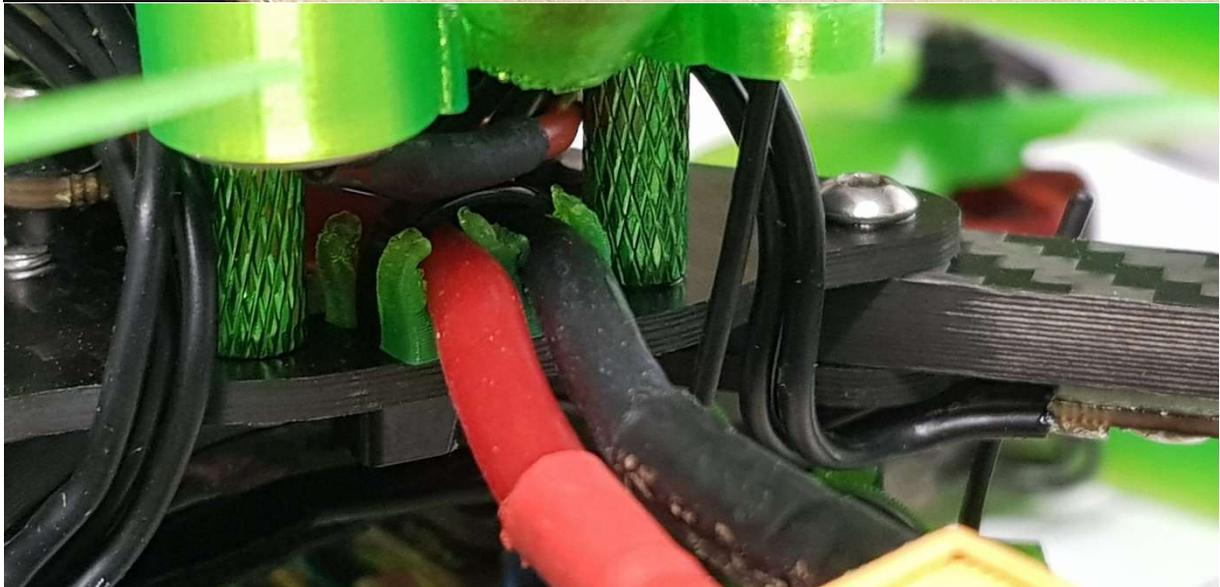
Hier sieht man einen eingesetzten Kabelspanner, er ermöglicht die Befestigung am Carbon ohne Gefahr das Kabel dabei zu beschädigen.
