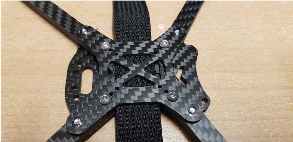
Von der Unterseite wird bei der Verwendung von 20x20 oder 25.5x25.5mm Montagebohrungen für den FC/ESC
