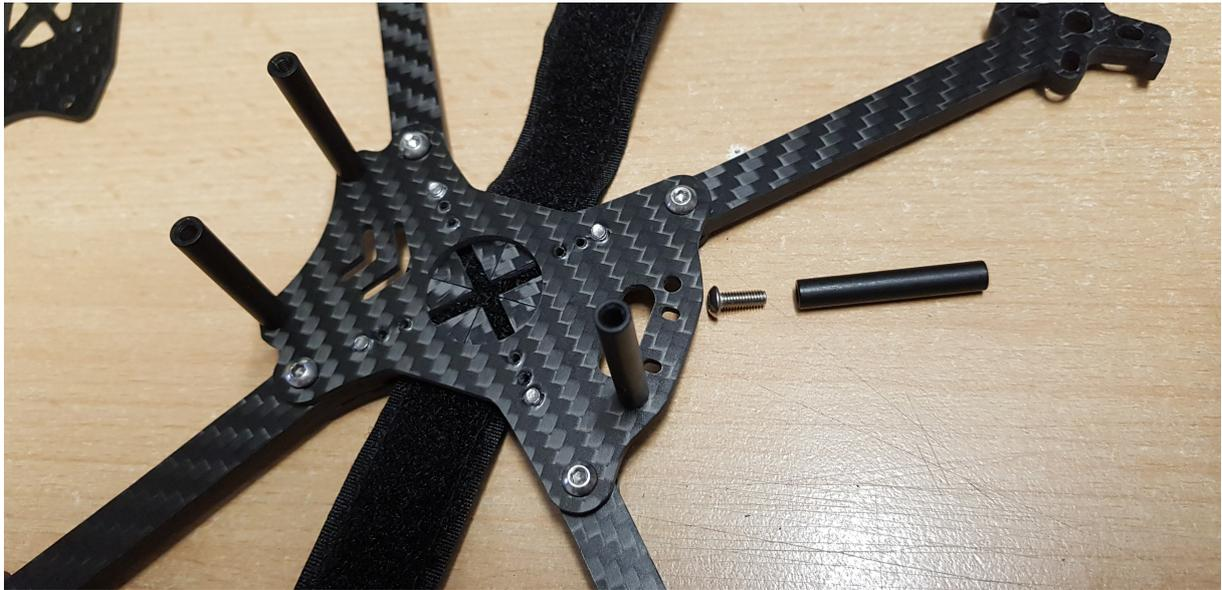
Jetzt können die 30mm Abstandshalter aus dem H22-EW KIT (Optional) mit M3x8mm Schrauben von unten angeschraubt werden. Auch hier verwende ich Schraubensicherungslack!
