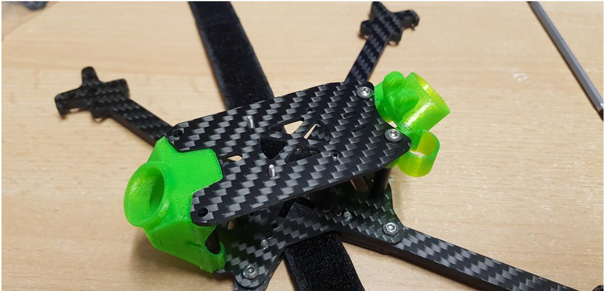
Wenn eine DJI Vista oder ein HDZero Race VTX (V1 oder V2 möglich) hier montiert werden soll müssen längere Schrauben verwendet werden! Nicht im Bausatz enthalten!
